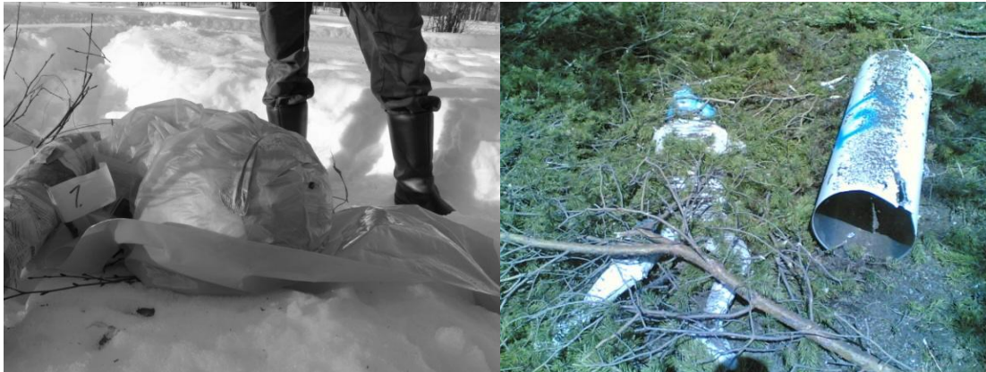
Kuva 3: Luodinreikä maalinuken päässä ja puussa räjähtänyt kranaatti ovat esimerkkinä kenttäkokeiden annista.
